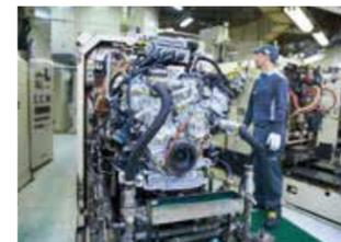
テストは自動で行われ、運転性能や法規制に適合しているかを約40種類の検査をしていきます。すべてに100点満点で合格したエンジンだけを出荷します。
