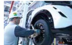
タイヤを仮り締め工具で取り付けした後、設備で規定の締め付けトルク値で取り付けます。
