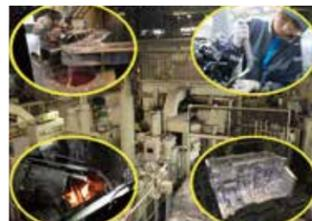
溶かした金属を金型に流し込み、冷やし固めて製造します。一般的に鉄やアルミが使用され、主にエンジン部品や足廻り部品等を鋳造で製造しています。
