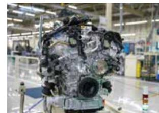
シリンダーブロックにシリンダーヘッドを組み付けるなど、自動組立行程と手作業組立行程を経て1台のエンジンとして組み立てられ、テスト行程に送られます。
