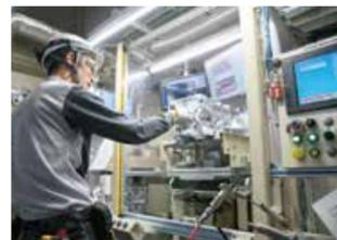
エンジンの主要部品であるシリンダーブロック、クランクシャフト、シリンダーヘッドを専用の機械を使い、切削・整形していきます。
